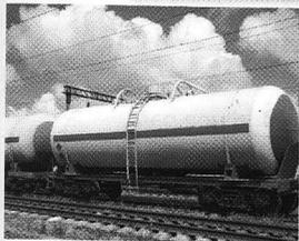
La cuve d'un wagon citerne a la forme d'un cylindre de 3 m de diamètre sur 11 m de long.
